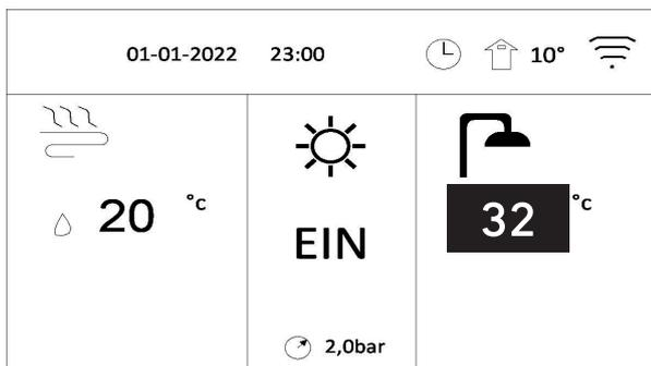
Wenn der Cursor auf der Warmwassertemperatur (DHW mode) steht, drücken Sie die Taste
