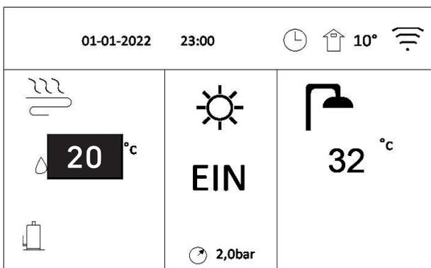
» Steht der Cursor auf der Temperatur des Raumbetriebsmodus (einschließlich Heizmodus, Kühlmodus und Automatikmodus), drücken Sie die Taste
